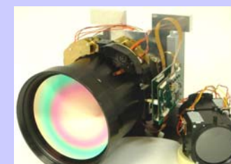
独自開発の防振機構搭載 遠赤外線カメラ用ズームレンズ
